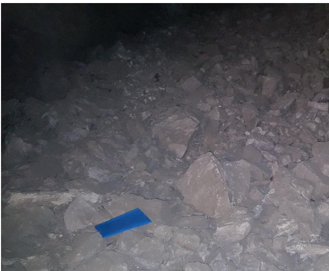
Figura 55 - Avaliação da granulometria do material originado pelo disparo com mais uma fiada nas frentes LS395B065 (à esquerda) e C6602B03 (à direita).
